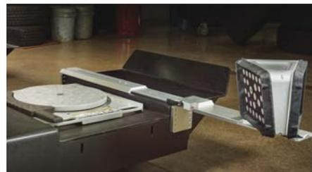
Las piezas de montaje se adaptan a los elevadores más comunes y pueden ser desmontadas con un sistema de liberación rápida.
