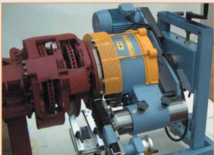
La TD 502 rivoluziona il concetto di tornitura dei dischi freno di veicoli industriali e autobus: non è più necessario smontare il disco per lavorarlo al tornio da banco ma è sufficiente applicare la macchina direttamente al mozzo.
