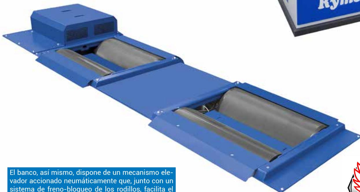
El banco, así mismo, dispone de un mecanismo elevador accionado neumáticamente que, junto con un sistema de freno-bloqueo de los rodillos, facilita el acceso y la salida del vehículo al banco. La fuerza de elevación máxima de dicho mecanismo es de 4.000 Kg en eje a 8 bares de presión.
