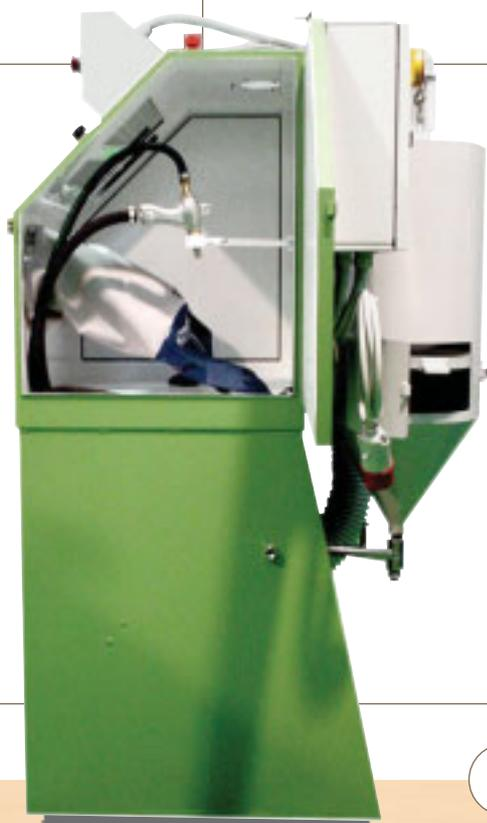
La pallinatrice LC/05 garantisce omogeneità per qualsiasi trattamento di finitura superficiale con grado di finitura costante e per la pallinatura non abrasiva con microsferi di vetro.
