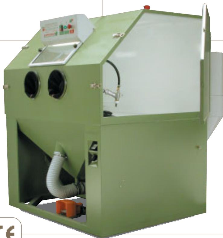
Le pallinatrici di grandi dimensioni LC/2 TR e LC/3 TR sono indicate per produzioni elevate con garanzia di omogeneità e grado di finitura costante. La tavola rotante, montata di serie su cuscinetti a tenuta stagna, permette la rotazione manuale di pezzi con forme complesse, facilitando le operazioni di sabbiatura/pallinatura.
