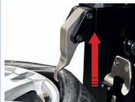
**Azionato da un potente cilindro pneumatico di diametro 90 mm, con movimenti fissi e prestabiliti, XTool è progettato per smontare il tallone dello pneumatico senza alcun contatto con il cerchio e senza rischi di danneggiamento dello stesso.**
